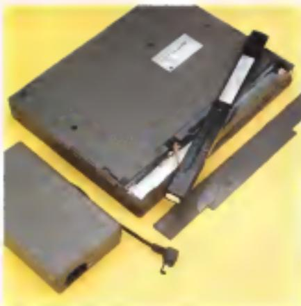
La batteria esterna delle due alette a fianco l'alimentatore.
